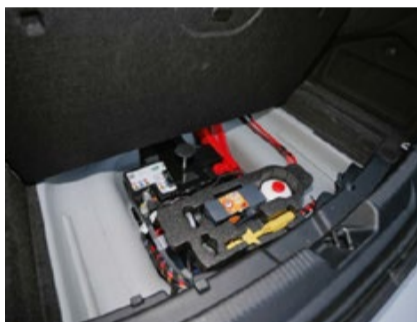
La batería ocupa el espacio de la rueda de repuesto, montando un kit antipinchazos.
